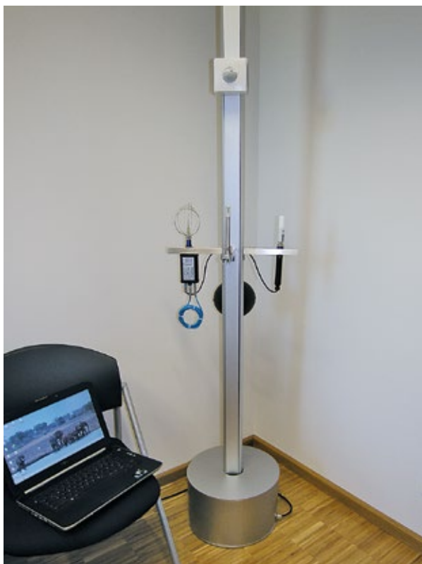
Überprüfung von Lüftungskonzepten durch CO 2 -Messungen
