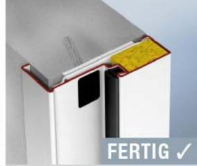
Anschlussfugen versiegeln und Befestigungslöcher abdecken.
