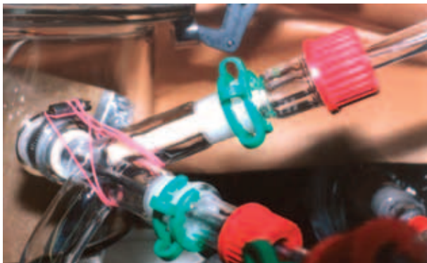
Bild 11: Ein mit Polyurethanschäum selbst bestücktes Sammelröhrchen (weiß im Bild) für die Adsorption von SVOC, hier während der Probenahme.
