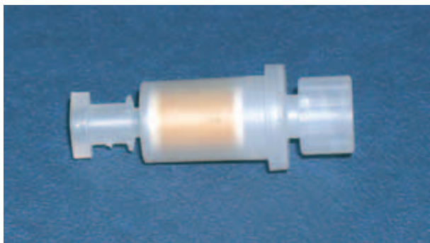
Bild 12: Kommerzielle Sammelkartusche, die DNPH auf einem Kieselgelträger enthält, für die Adsorption von Aldehyden und Ketonen.
