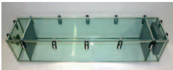
Bild 9: Ansicht der Emissionskammer CLIMPAQ, die ein Fassungsvermögen von etwa 35 Litern hat. Der Raum, der für die Materialprobe vorgesehen ist, ist jeweils auf der Seite der Luftzuführung und der Luftabführung durch eine Drahtgaze abgetrennt. Sie bewirkt, dass der Luftstrom laminar über die Materialprobe hinwegstreicht.
