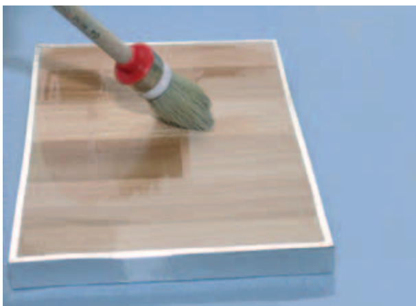
Bild 22: Pinselauftrag von acrylbasiertem Lack auf eine geleimte Massivholzplatte zur Vorbereitung der Prüfkammermessung
