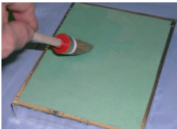
Bild 7: Pinselauftrag von Tiefengrund auf Gipskarton, die Schnittkanten der Gipskartonprobe wurden mit selbstklebender Aluminiumfolie verschlossen.
