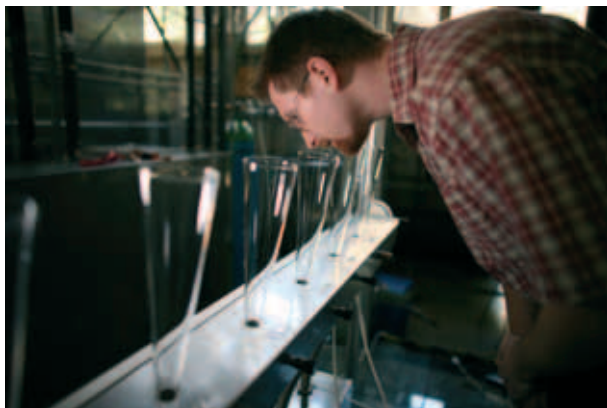
Bild 14: Vergleichsproben für die Prüfung der Geruchsintensität. Die Vergleichsproben entsprechen Konzentrationen zwischen 0 und 15 pi. 1 pi entspricht der Geruchsschwelle, bei der der Vergleichsstoff gerade wahrnehmbar ist. Je intensiver der Proband den Geruch empfindet, umso größer ist der Wert pi. Im Forschungsprojekt reichte die Skala bis 30. Den Probanden steht es frei, Geruchsintensitäten zu extrapolieren
