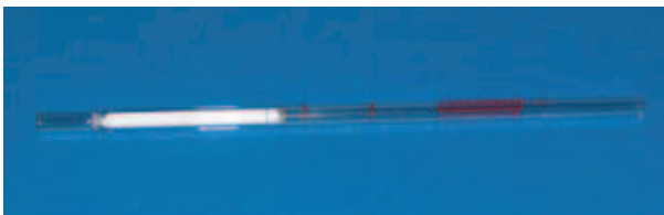
Bild 10: Kommerzielles selbst befülltes Tenax-TA-Sammelröhrchen für die Adsorption von VOC
