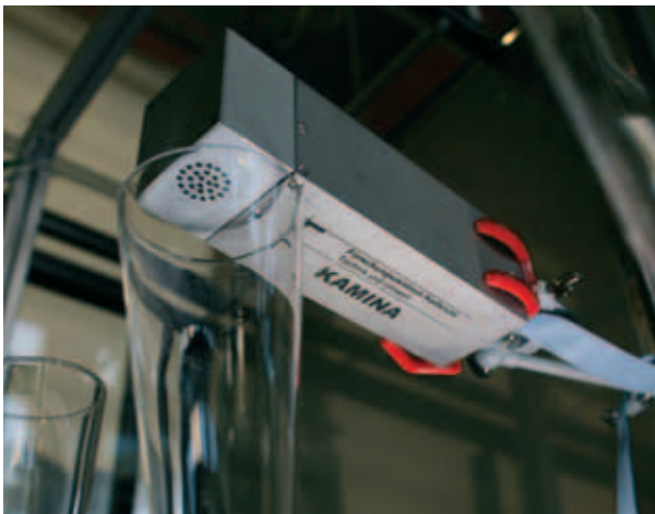
Bild 16: Die im Forschungszentrum Karlsruhe entwickelte künstliche Nase Kamina beim Messvorgang über einem Bewertungstrichter
