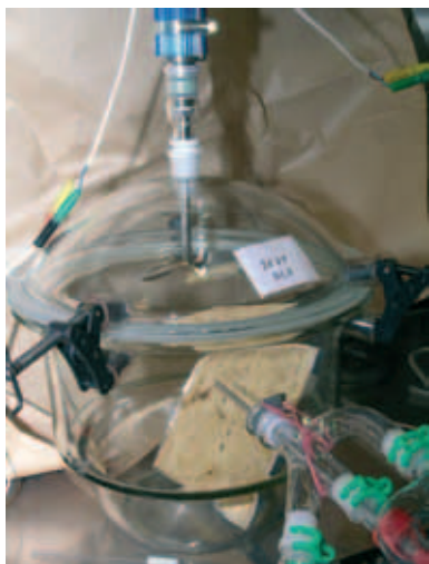
Bild 8: Emissionskammer (Exsikkator) mit der Materialprobe einer OSB, das Fassungsvermögen beträgt 20 Liter.
